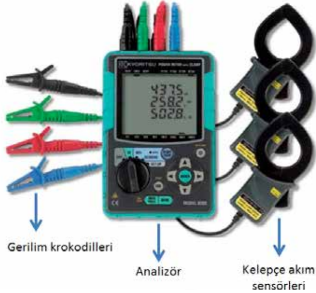
Şekil 1. Kyoritsu 6300 taşınabilir güç analizörü.
